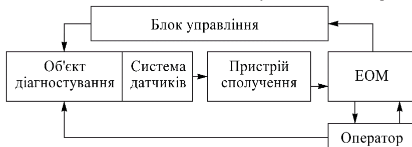
Рисунок 2 – Структурна схема системи технічного діагностування
